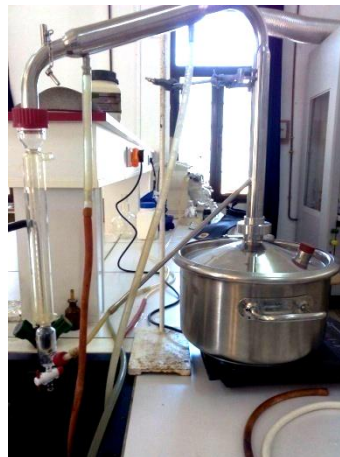
Figure 25 : L'extraction par l'entraînement à la vapeur (Originale, 2016)
