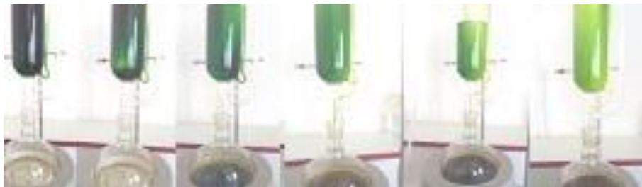
Figure 31. Les cycles d'extraction par l'extracteur de Soxhlet de l'extrait hydro-alcoolique de M. piperita (Originale, 2016)
