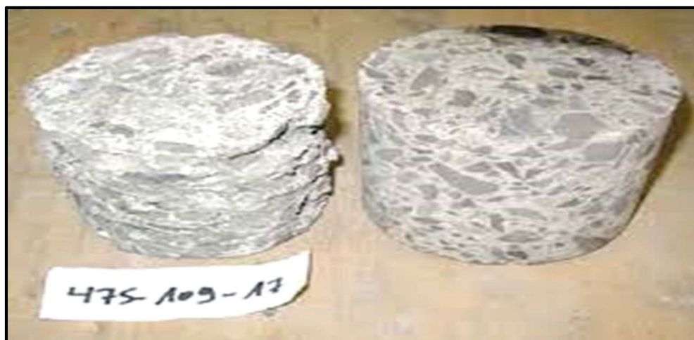
Figure I.4 : Carotte de béton sous mise pendant 27 jours a des cycles d'attaque à l'acide acétique à gauche et à titre de comparaison, une carotte de béton identique, non soumise aux essais identique à droite.
