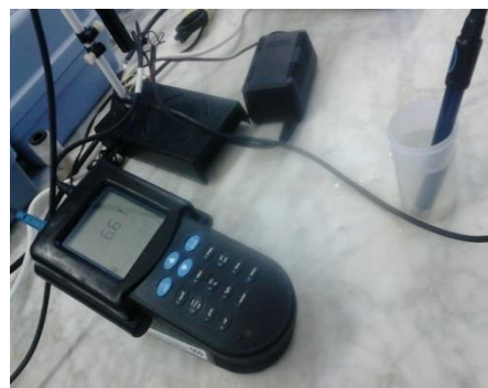
Figure IV.4: pH mètre (électrode de verre)
