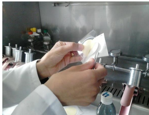
Fig. IV.14: Déposition de la membrane filtrante sur le milieu Endo
