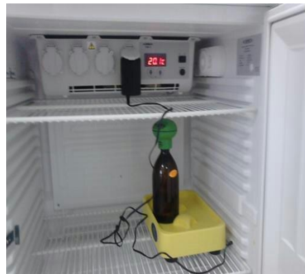
Figure IV.6 et IV.7: Bouteille de DBO 5 placée dans l'étuve thermostatée à 20 °C
