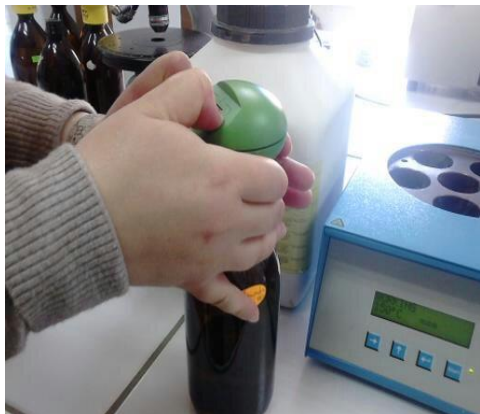
Figure IV.6 et IV.7: Bouteille de DBO 5 placée dans l'étuve thermostatée à 20 °C
