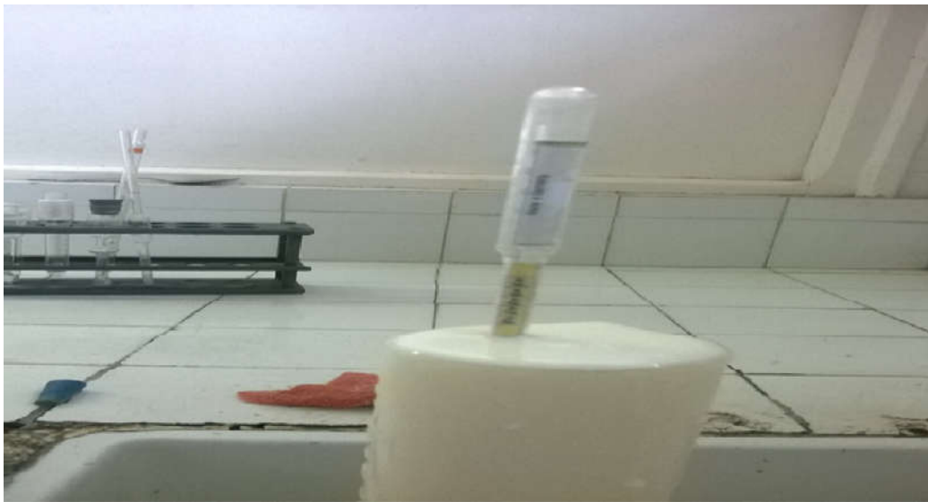
Image 5 : le thermo-lactodensimètre dans un échantillon de lait
