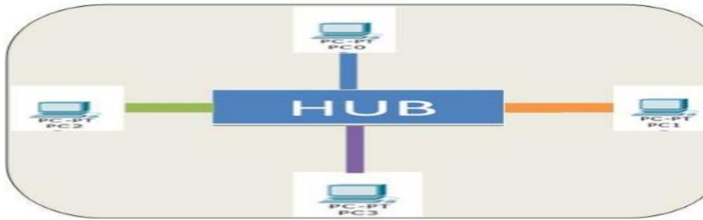
Figure I.2 : Topologie en étoile
