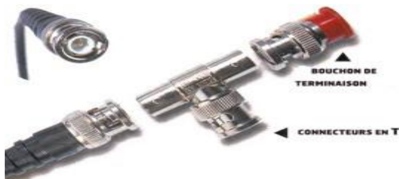
Figure I.10 : Câble coaxial et le connecteur BNC
