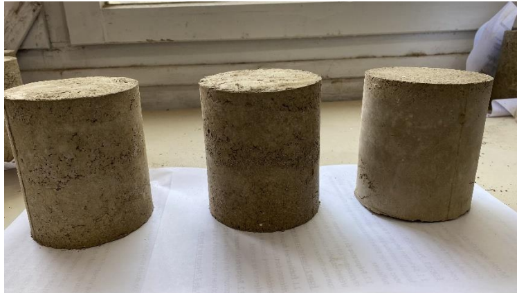
Figure III.22 : Eprouvettes cylindriques durant le suivi de la perte de masse.
