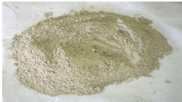
Figure 2 : Bentonite en poudre
