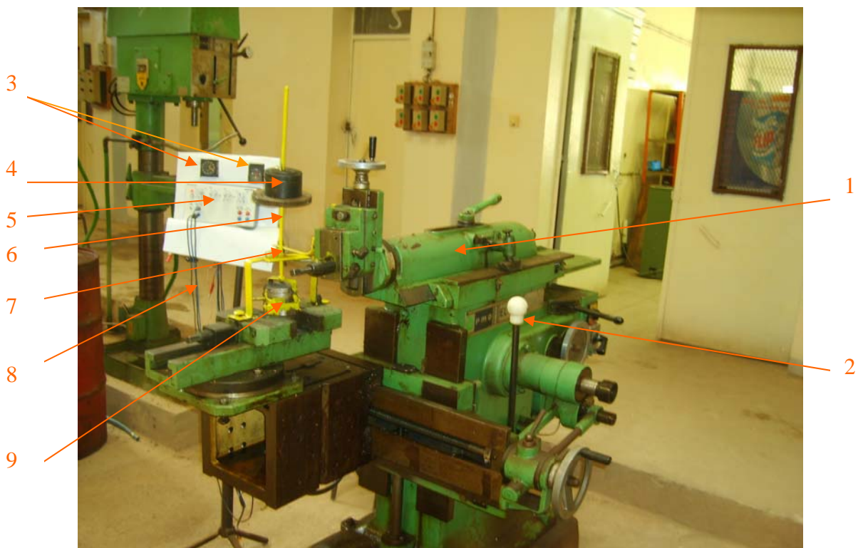
Figure II.14. Banc d'essai usure par fatigue
