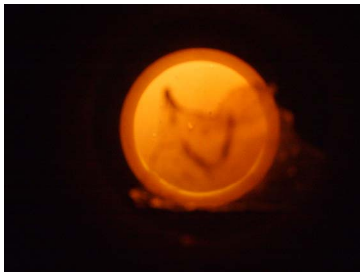
Figure II.8. Traces d'usure sur la silicone
