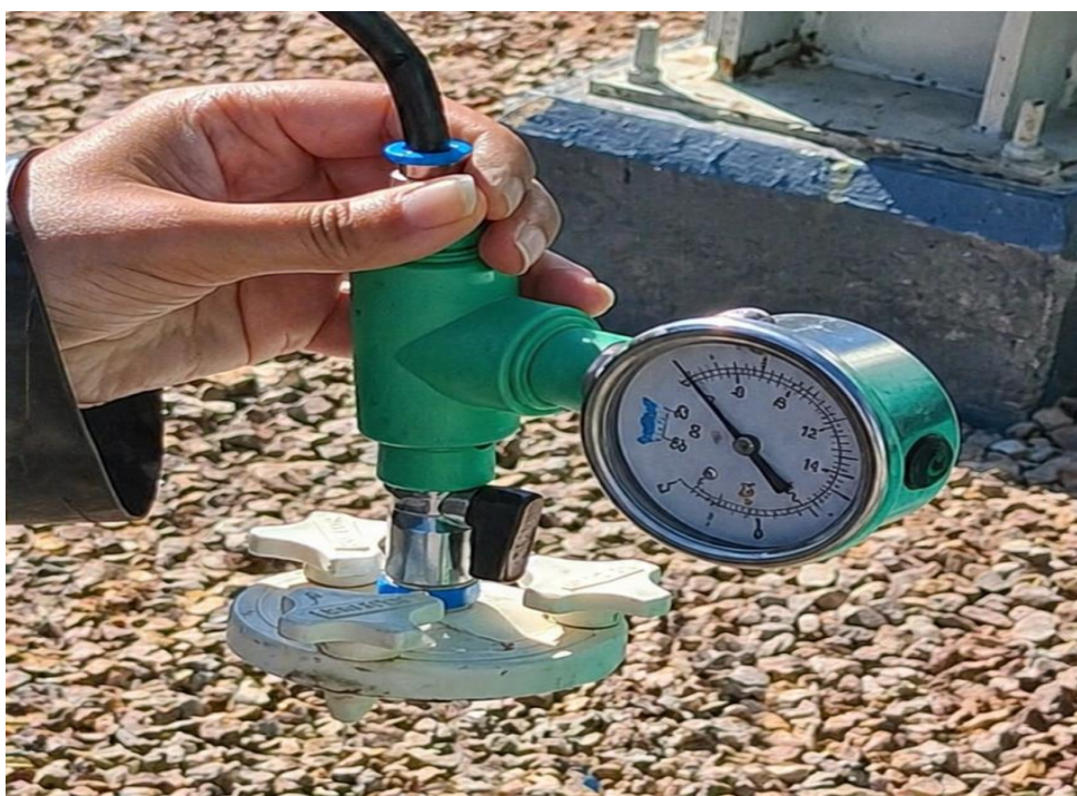
Figure II-11 : Manomètre utilisé pour la mesure de la pression.
