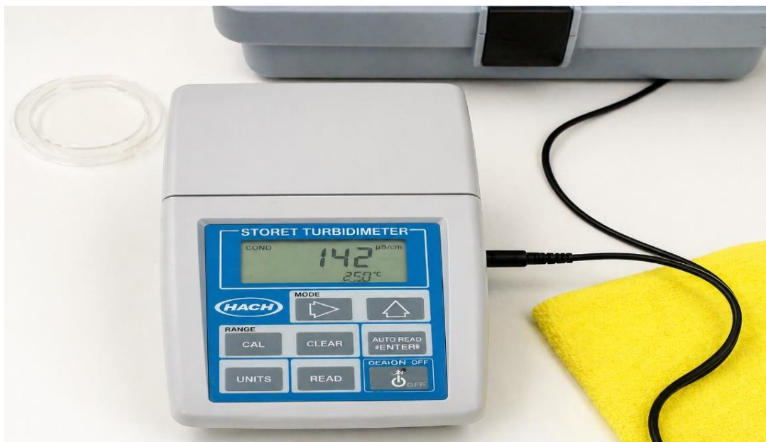
Figure II-8 : Le dispositif de la mesure du turbidité (Turbidimètre).
