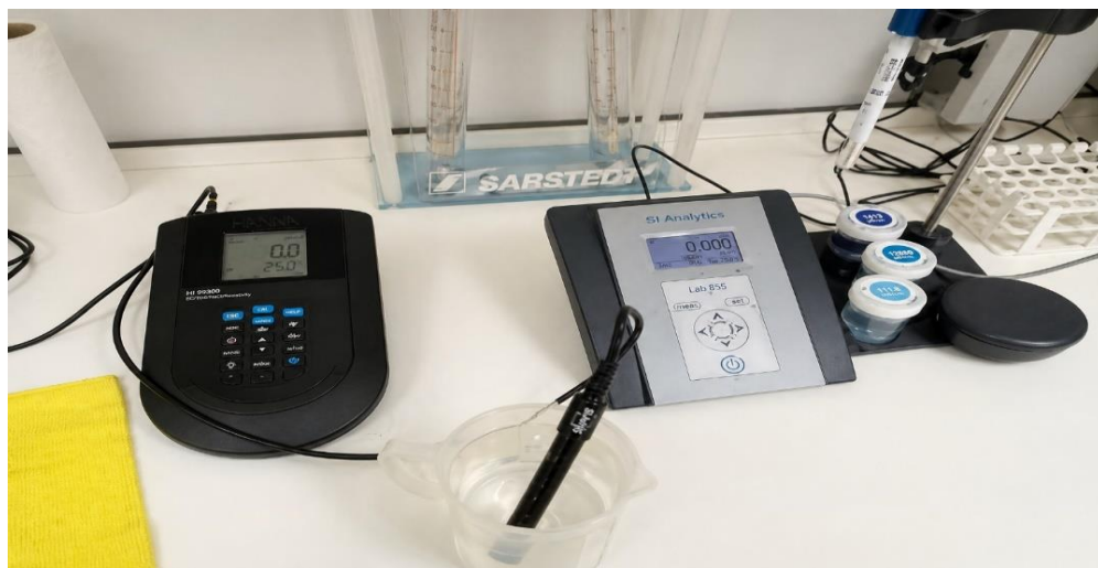
Figure II-2 : Dispositif de mesure de la conductivité.
