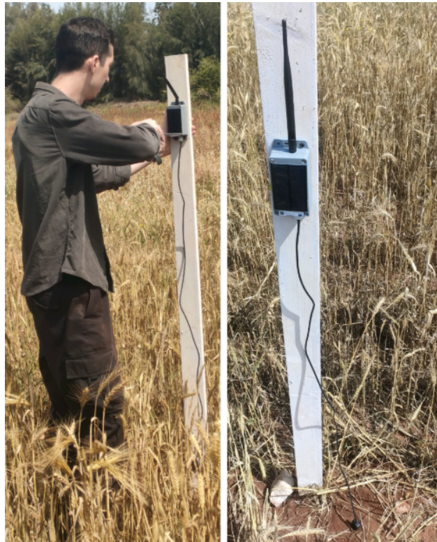
FIGURE III.4 – L'installation de capteur Intel-IrriS sur la surface
