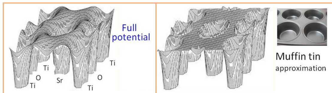
Figure III. 3 : Potentiel cristallin dans la SrTiO 3 : (a) potentiel total et (b) potentiel muffin-tin. [54]
