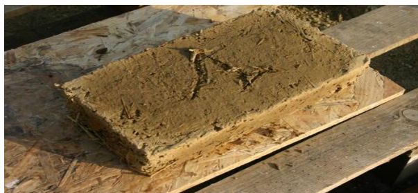
Photo 13 : d'une brique de terre crue
