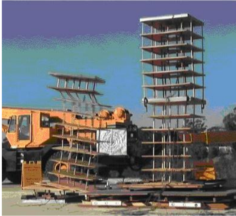
Photo3 : Essai d'un modèle classique de bâtiment (gauche) et d'un modèle à isolement bas (droite)
