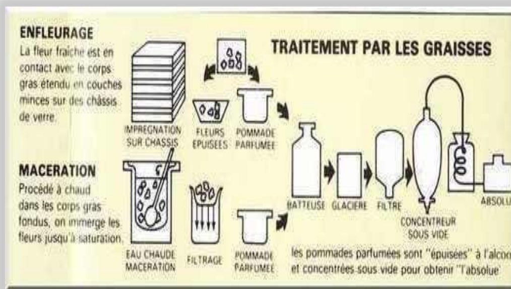
Figure n°13 : Schéma du principe de la technique d'extraction par enfleurage ( Lucchesi et al., 2004 ).
