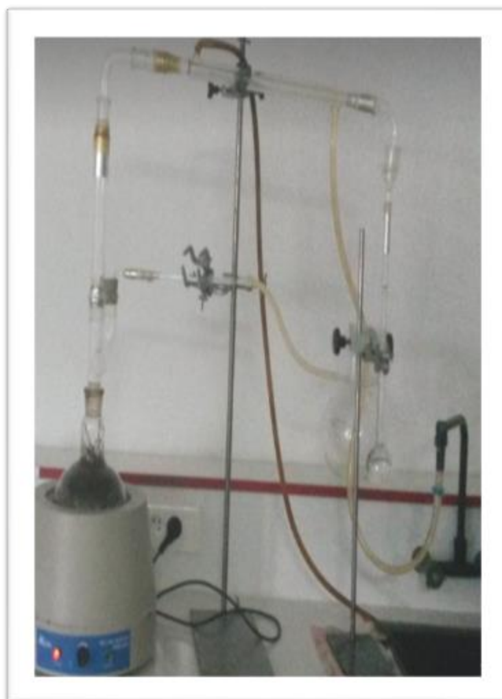
Figure n°28 : Extraction de l'huile essentielle d' Artemisia herba alba par hydrodistillation.
