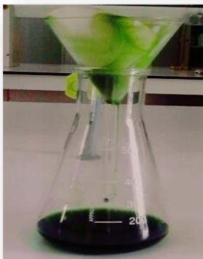
Figure7. méthode de filtration des extraits hydro alcooliques de thymus vulgaris
