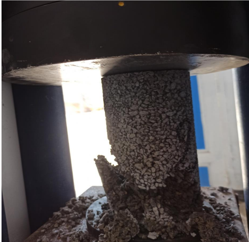
Figure 40-III : Resistance à la compression sur éprouvette 11x22
