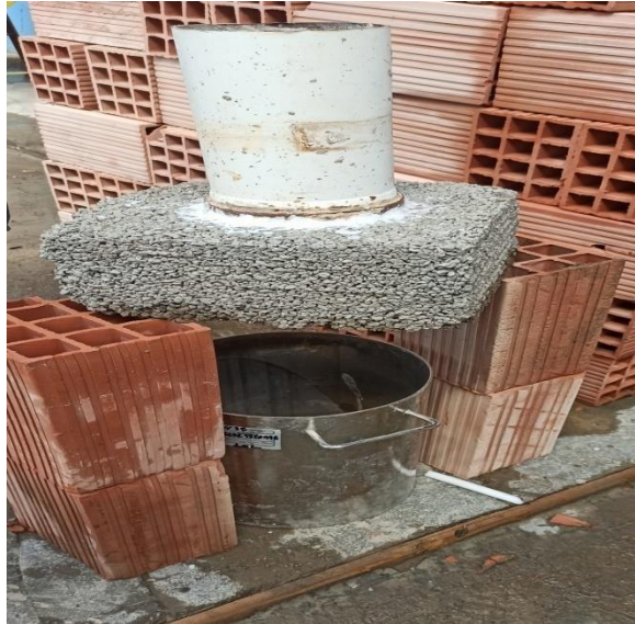
Figure 39-III: essai de perméabilité à l'eau
