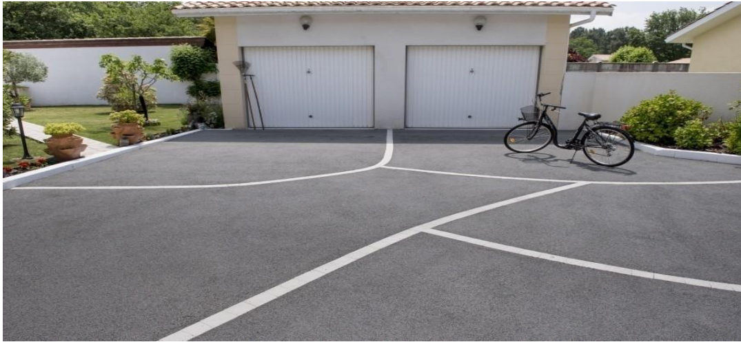
Figure 6-i: Autour d'une maison en béton drainant.
