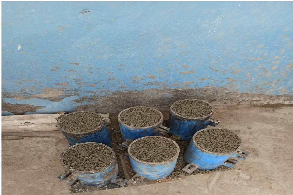
Figure 29-II: Béton drainant adjuvanté au réducteur d'eau
