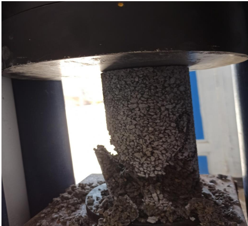
Figure 37-II: Essai de la résistance à la compression
