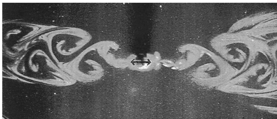
Fig. 1.4 – Détachement tourbillonnaire à \beta = 42 pour Kc = 4.4 -régime C. [9]
