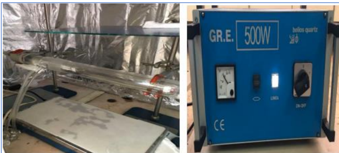
Figure II.7 Le réacteur photochimique doté de sa lampe UV.
