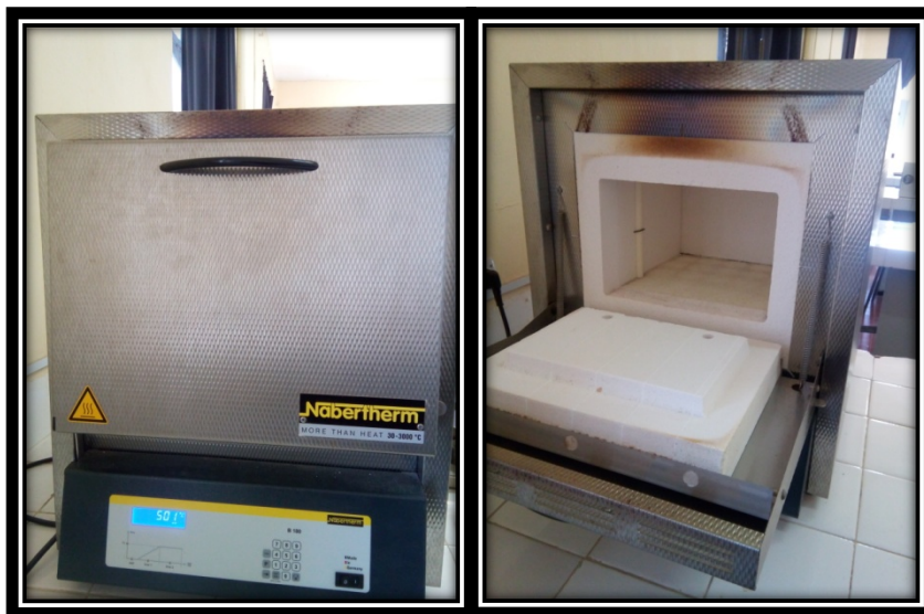
Figure 21: Four à moufle utilisée lors de notre étude (Photo prise par Addjal et Diffalah, 2017).
