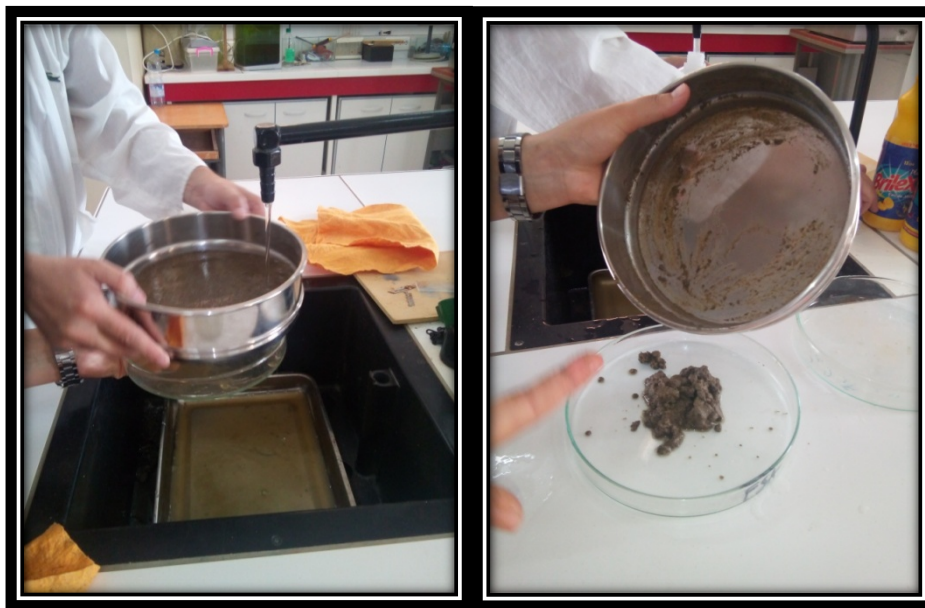
Figure 23: Tamisage humide des échantillons (Photo prise par Addjal et Diffalah, 2017).
