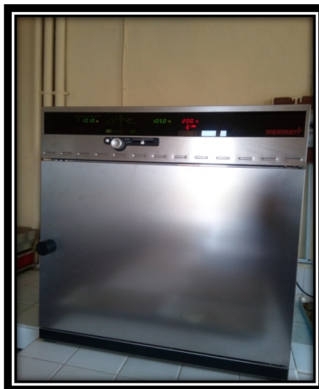
Figure 20 : Etuve de type MEMMERT utilisée lors de notre étude (Photo prise par Addjal et Diffalah, 2017).
