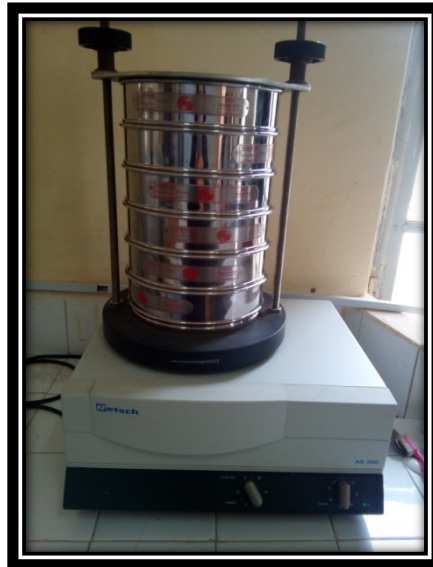
Figure 24: Tamiseuse avec et une série de tamis norme AFNOR utilisée lors de notre étude (Photo prise par Addjal et Diffalah, 2017).
