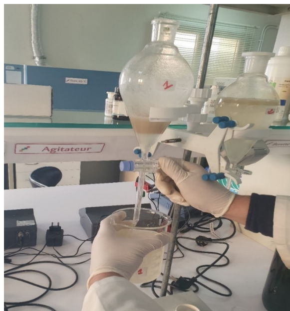
Figure II.7. Récupération des deux phases.
