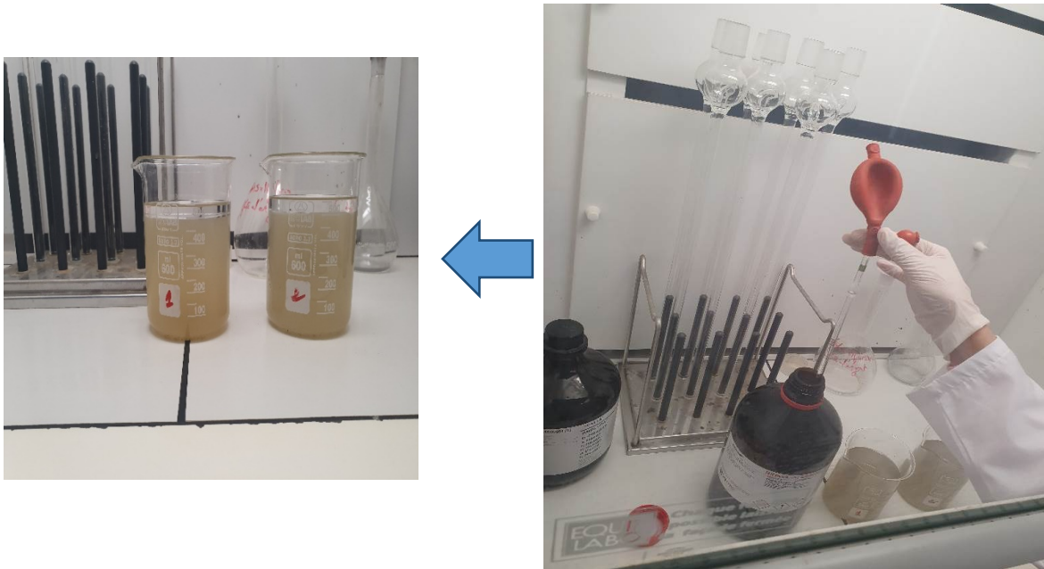
Figure II.3. Création des deux phases à l'aide d'hexane.
