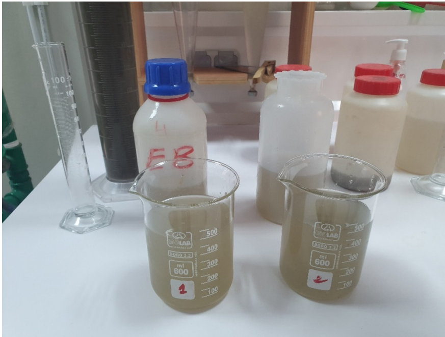
Figure II.1. Eaux brute (1), eau après prétraitement(2).
