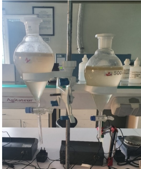
Figure II.6. Séparation des deux phases.
