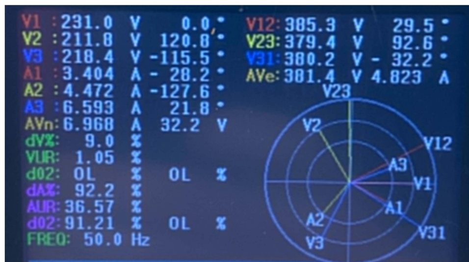
FIGURE 4.9. Résultats de mesure : Essai 3 — Chute de tension L2 + Charge 50% (afficheur de l'analyseur)
