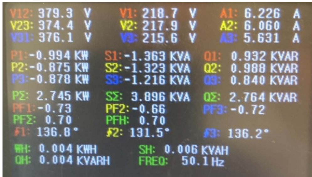
FIGURE 4.6. Résultats de mesure : Essai 2 — Charge nominale 50%
