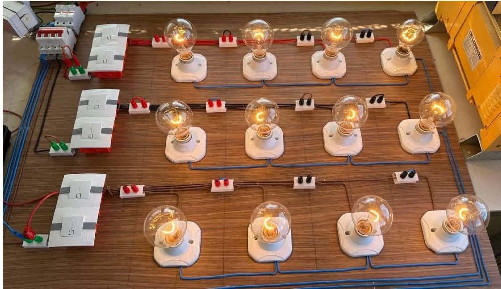
FIGURE 3.2. Tableau de Charge Résistive
