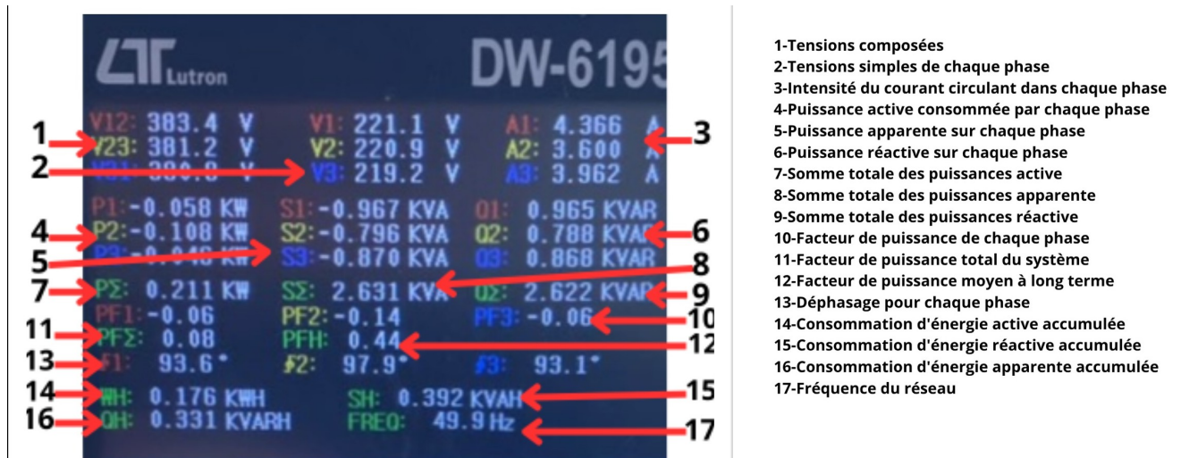
FIGURE 4.2. Résultats de mesure : Essai 1 — Marche à vide (afficheur de l'analyseur)
