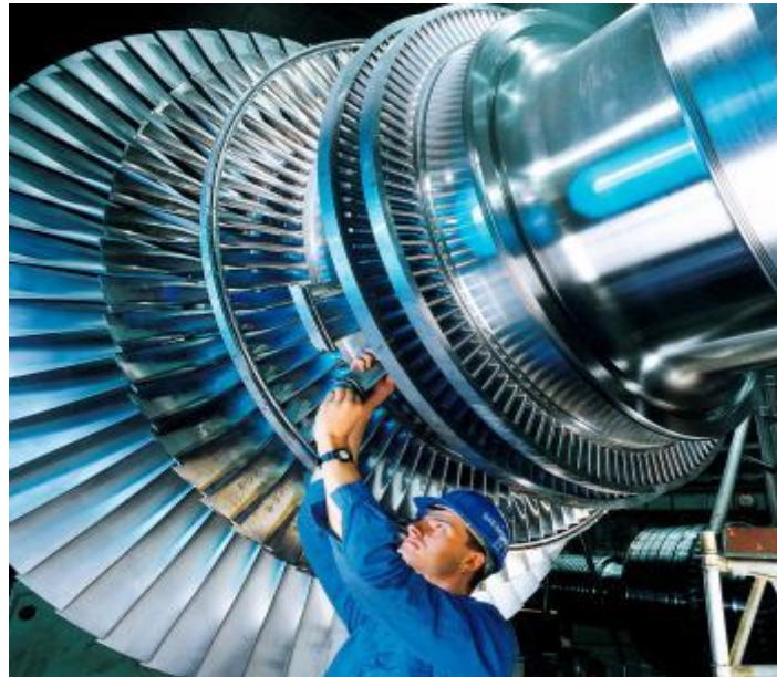
Figure 1.3 : étages d'une turbine à vapeur [4].
