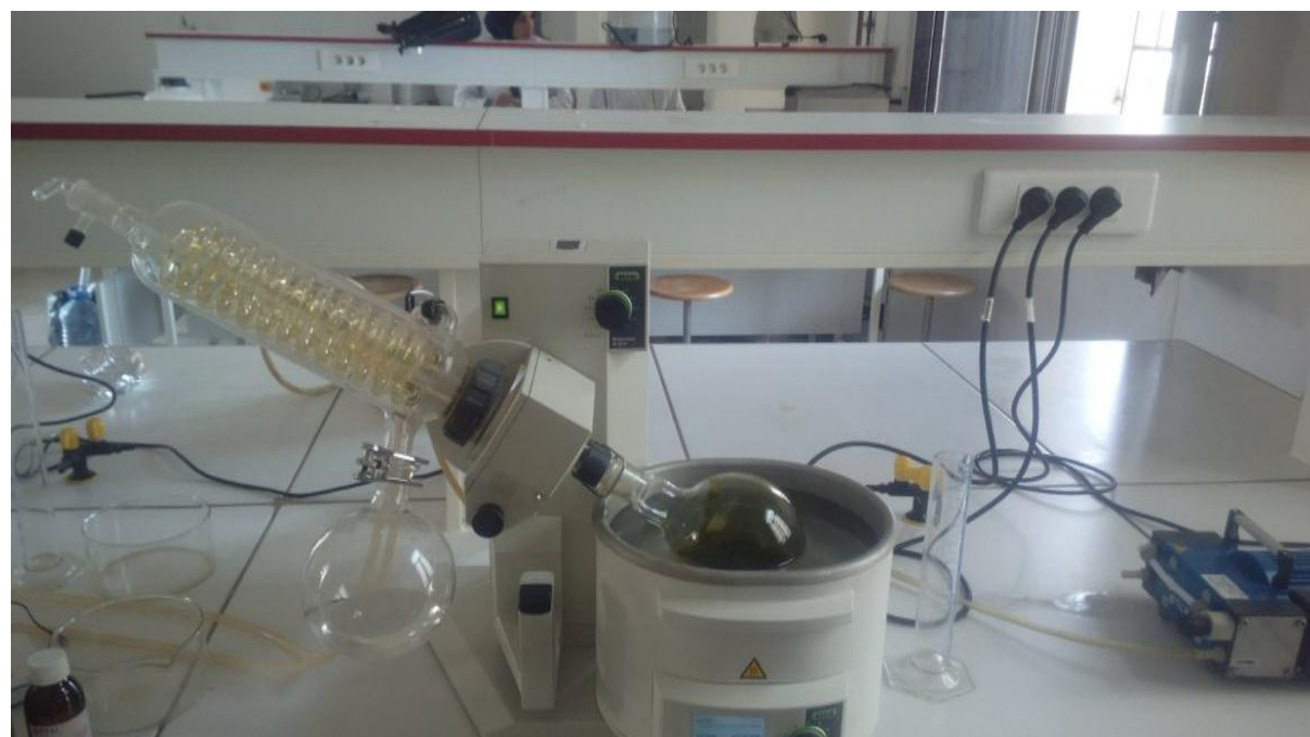
Figure 09: Évaporation du solvant (eau) sous vide par Rota vapor
