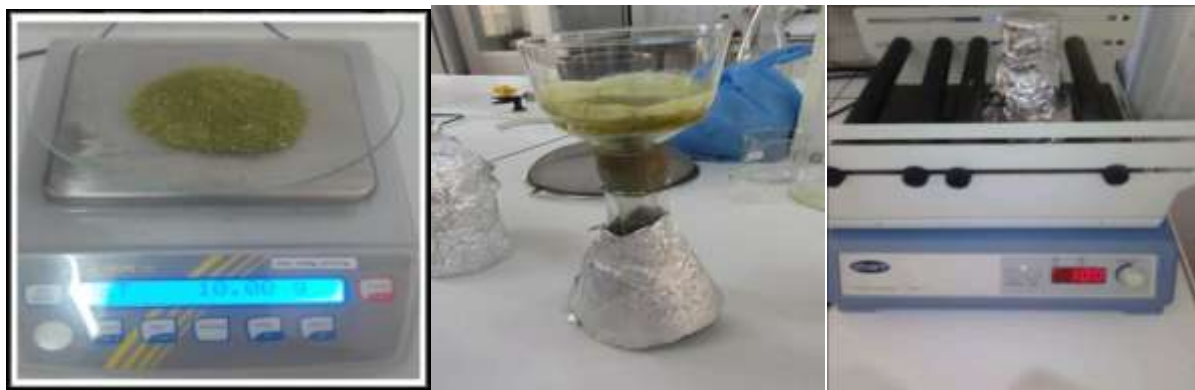
Figure7. Prise d' Echantillons de 10 g. Figure 8. Macération des échantillons Figure 9. Filtration de l'extrait
