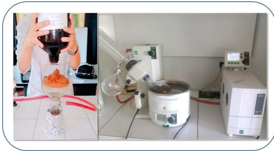
Figure 12 : Filtration sous vide et évaporation du solvant d'extraction de l'extrait éthanolique de W. frutescens [Originale].
