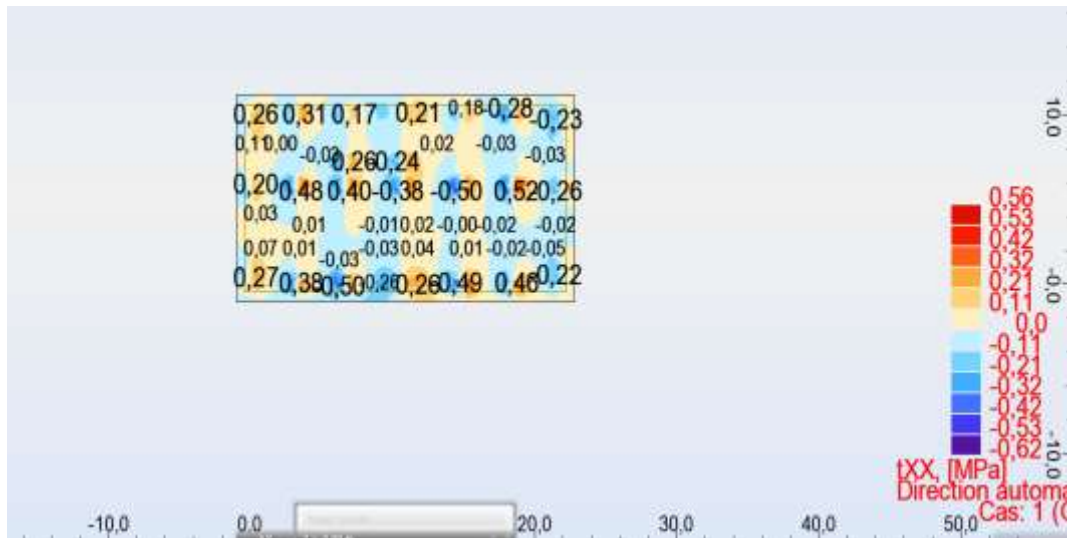
Figure 41. Distributions des Contraintes de cisaillement \tau_{xx}
