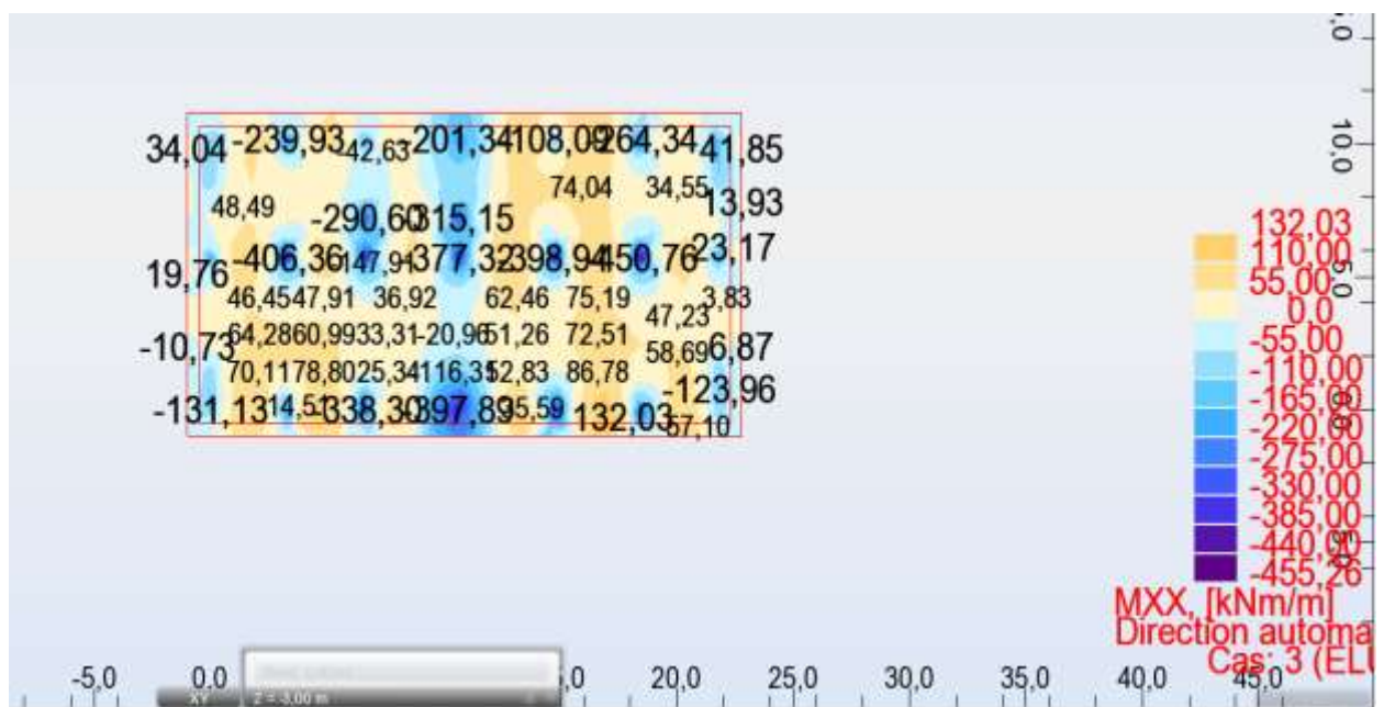
Figure 44. Distributions des moments fléchissant à l'ELU
