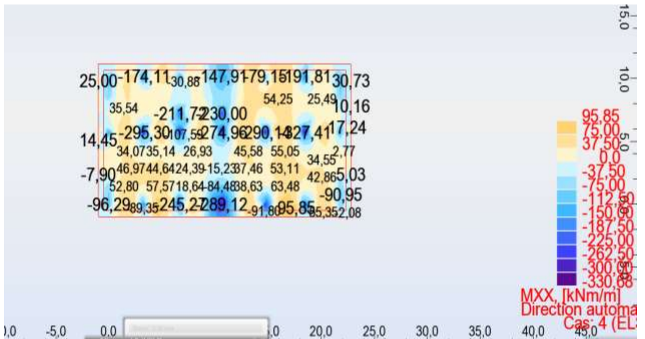
Figure 43. Distributions des moments fléchissant à l'ELS
