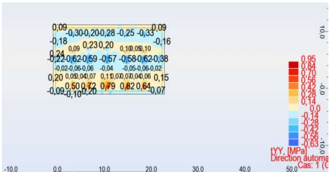
Figure 42. Distributions des Contraintes de cisaillement \tau_{yy}
