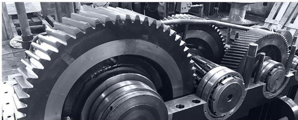
Figure II.11 : Multiplicateur de vitesse
