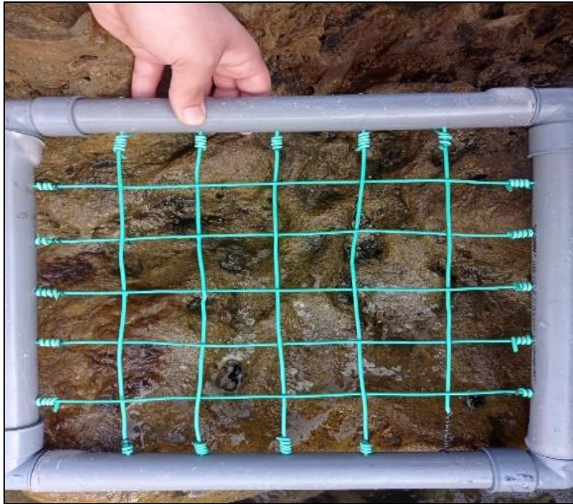
Figure 9 : Quadrat (de 30 cm de chaque cotée) utilisé pour échantillonnage.
