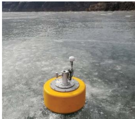
Figure 1.3. Bouée mobile pour la surveillance et l'évaluation en temps réel de la qualité de l'eau [11].
