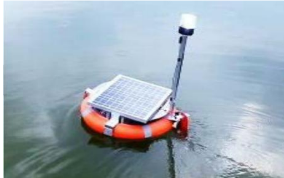
Figure 1.2. Bouée mobile pour la surveillance et l'évaluation en temps réel de la qualité de l'eau [10].
