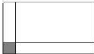
Figure II.10. Surface d'influence du poteau d'angle.
