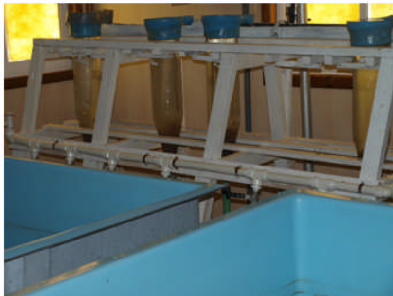
Figure 7 : Bouteilles de Zoug et auges d'incubation
