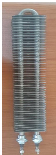
Figure III.14. Résistance électrique chauffante à ailette et son emplacement dans le circuit aéraulique
