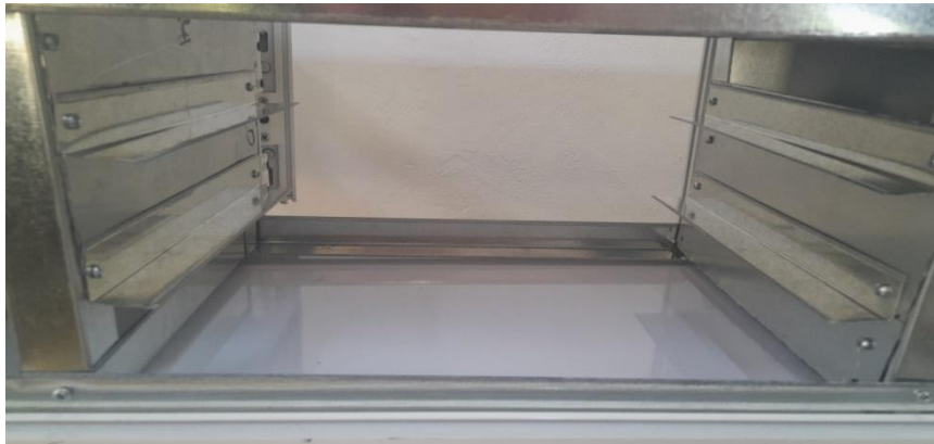
Figure III.6. Découpe et fabrication des étages dans lesquels sont placés les matériaux à sécher.
