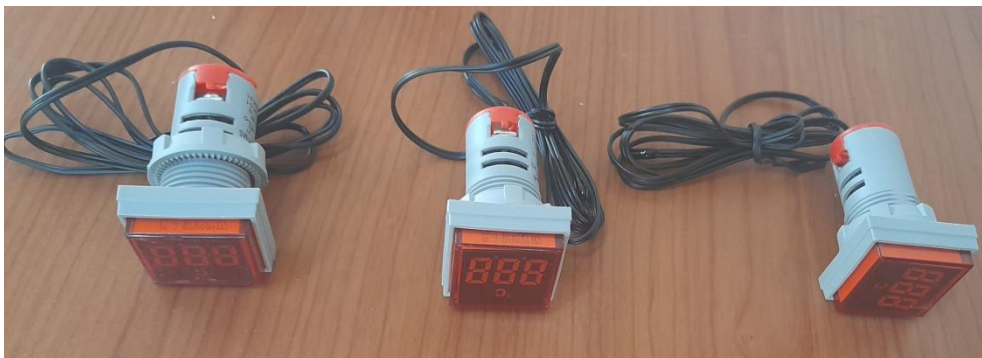
Figure III.17. Capteurs de température (digital panel light)
