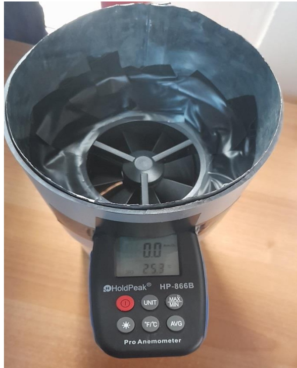
Illustration de la fermeture de la sortie d'air pour tenir compte du débit d'air
