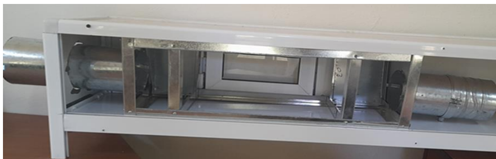
Figure III.10: Les étapes de fabrication du diffuseur d'air
