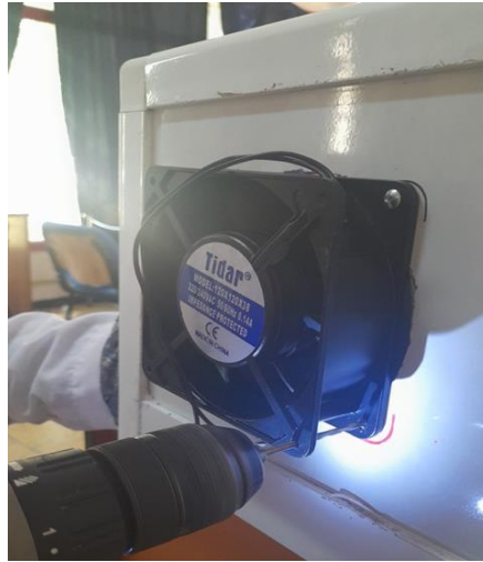
Figure III.13 Ventilateur axial fixé par boulonnage sur le séchoir
