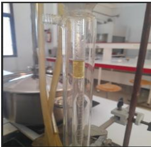
Figure 17 : l'huile essentielle récupérée dans une burette graduée
