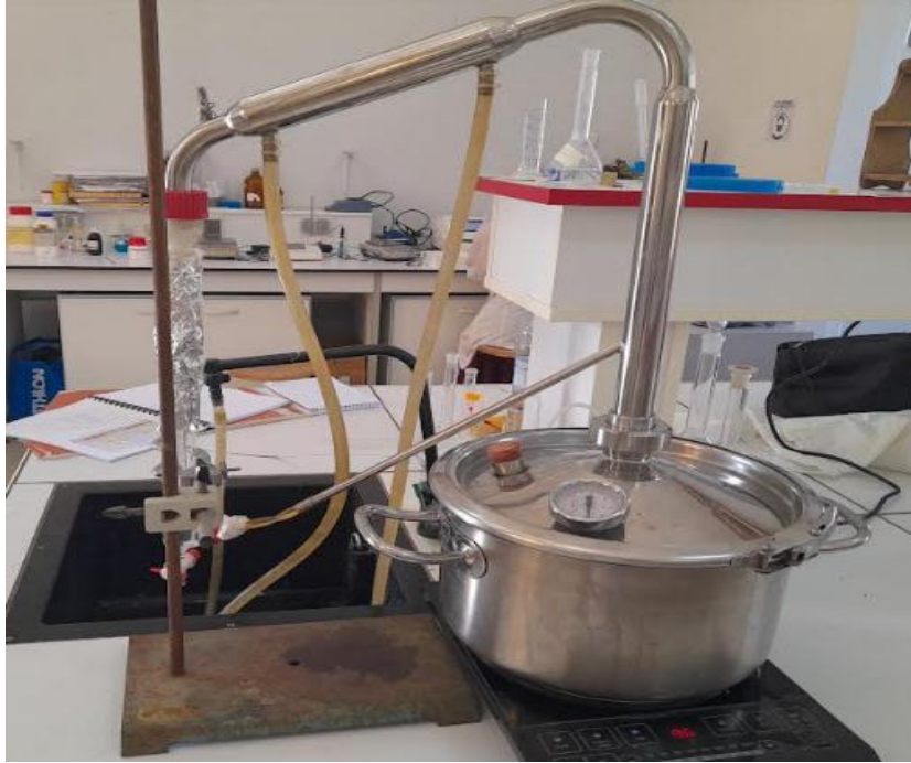
Figure 16 : Extracteur de l'huile essentielle par entrainement à la vapeur d'eau (Photo prise au niveau de laboratoire de biochimie 1)
