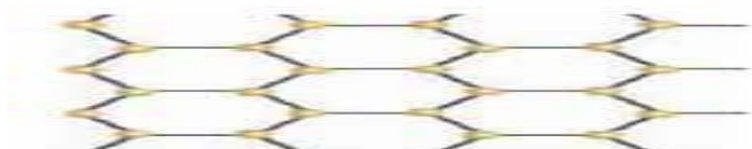
Figure9. Une feuille de graphène
