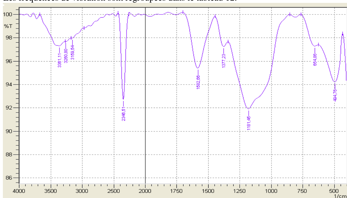
Figure48- Spectre FT-IR dans la région 400-4000 \text{cm}^{-1} de l'algue brune pyrolyse activée chimiquement par H 3 PO 4 à 20%.
