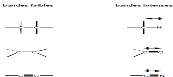
Figure20. L'effet de la liaison sur l'intensité des bandes.
