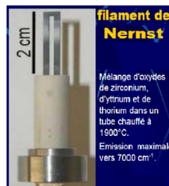
Figure28. Filament de Nernst
