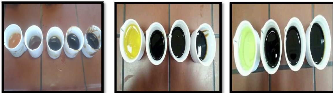
Figure V.2. Echantillons (BS, SAE 30, SAE 10) dégradés à T = 200 °C.
