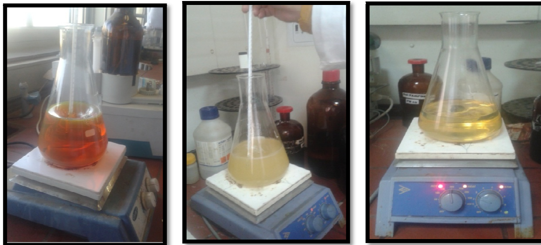
Figure V.1. Dégradation des différents grades d'huile de base (BS, SAE30, SAE10).
