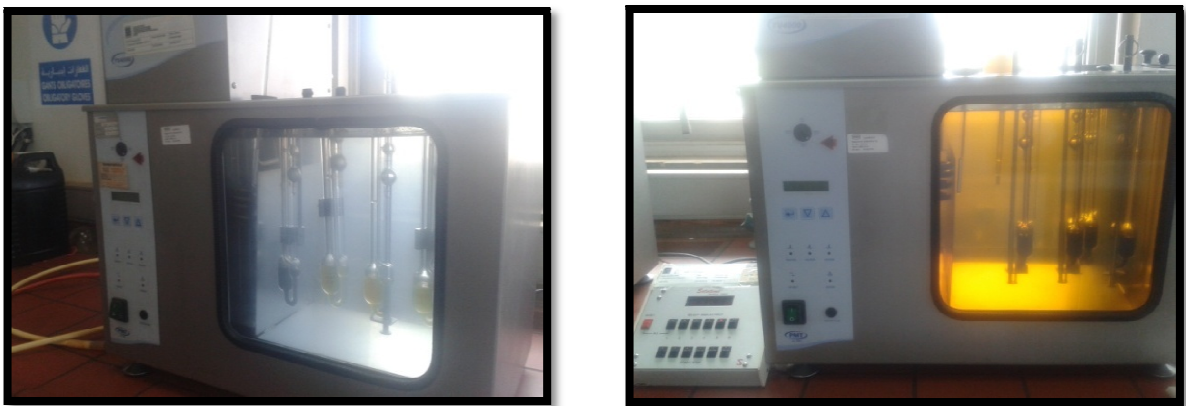
Figure III.6. Bain thermostaté de mesure de la viscosité à 40 °C et à 100 °C.
