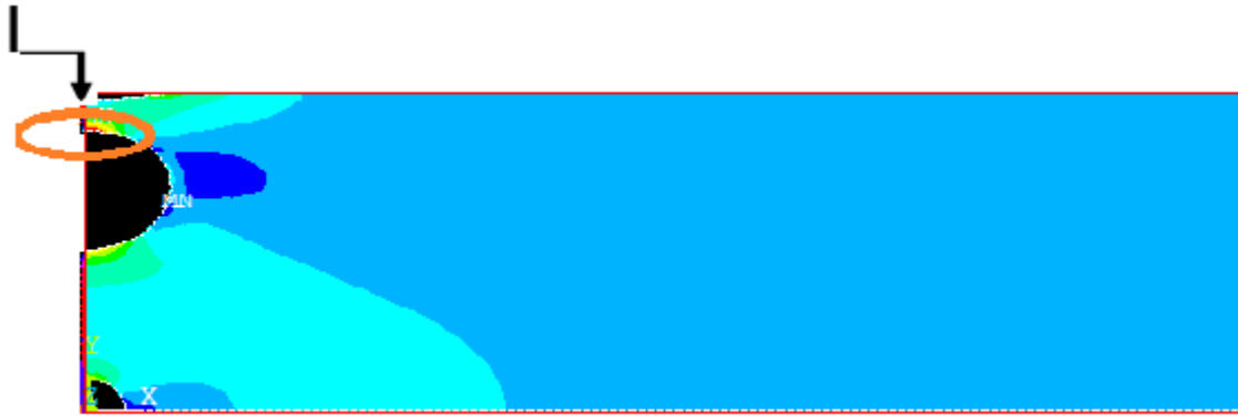
Figure II.18. Zone critique due à la contrainte moyenne de traction
