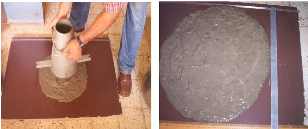
Figure 6. 5 : Après confection, passage aux essais de caractérisation, G/S = 1.2
