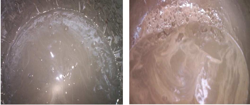
Figure 6. 4 : Exemple de BAP fluide (à gauche) et ségrégé (à droite), G/S = 1
