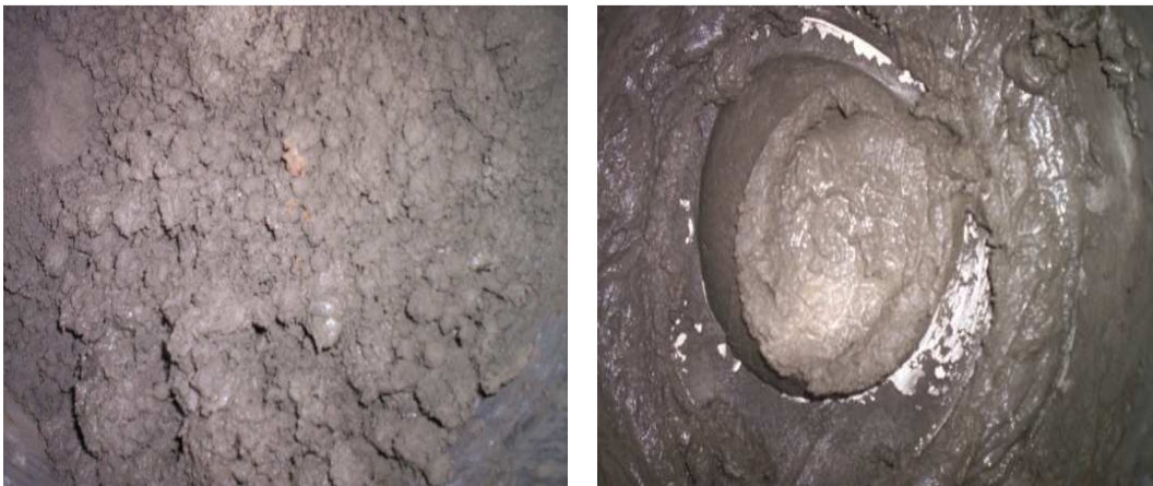
Figure 6. 3 : Exemple de BAP sec (à gauche) et un peu ferme (à droite), G/S = 0.8
