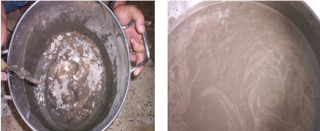
Figure 6. 2 : Procédure de confection d'un BAP par ajout de granulats secs et malaxage
