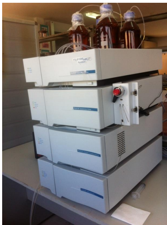
Figure II. 4 : photographie du chromatographe Young Lin (04 compartiments)
