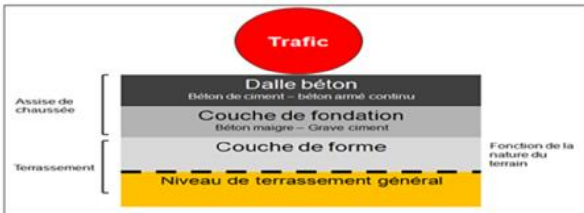
Figure 7.3 : Structure type d'une chaussée rigide.
