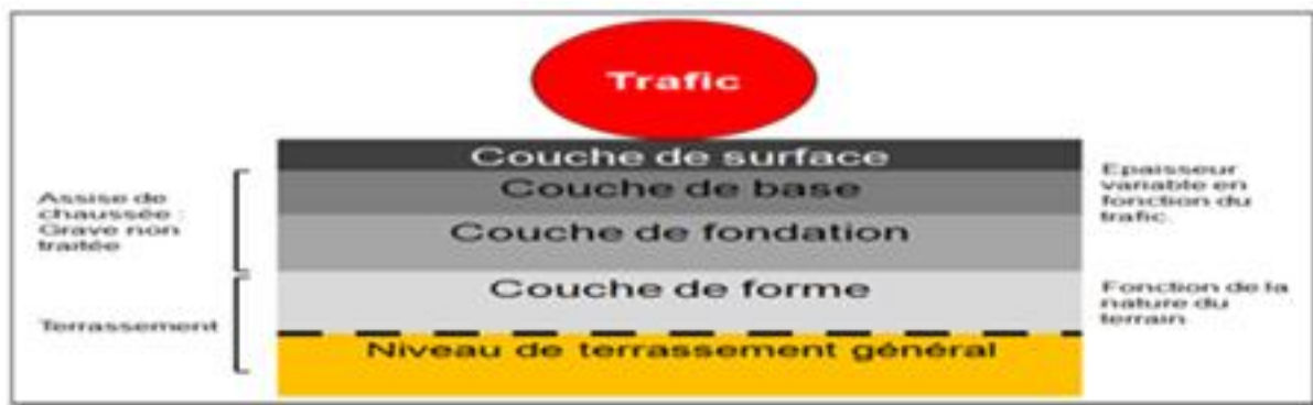
Figure7.1 : Structure type d'une chaussée souple.
