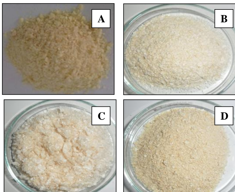
Figure 36. Aspect final du chitosane obtenu par différentes méthode d'extraction de la chitine. (A et B) extraction chimique de la chitine, (C et D) extraction enzymatique de la chitine.
