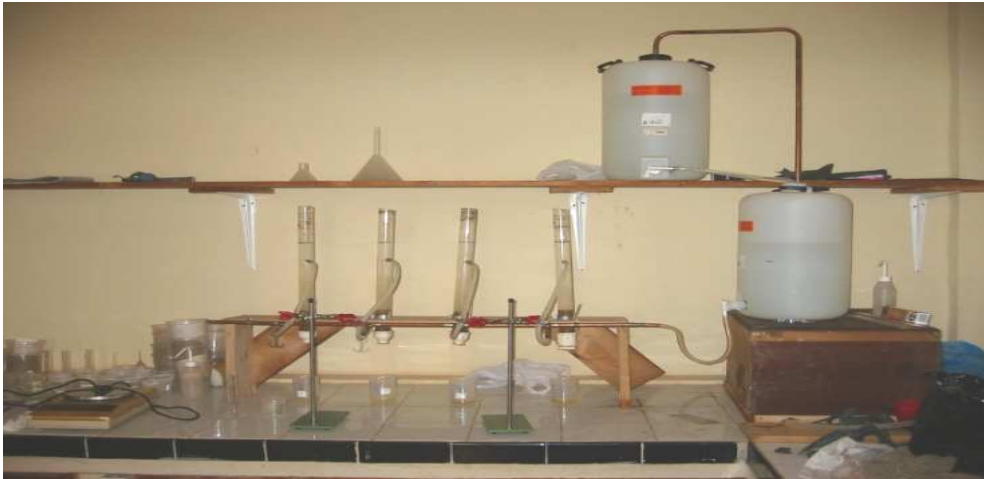
Planche 3: Dispositif de mesure de la perméabilité sur échantillon remanié (d'après Guy, 1978)
