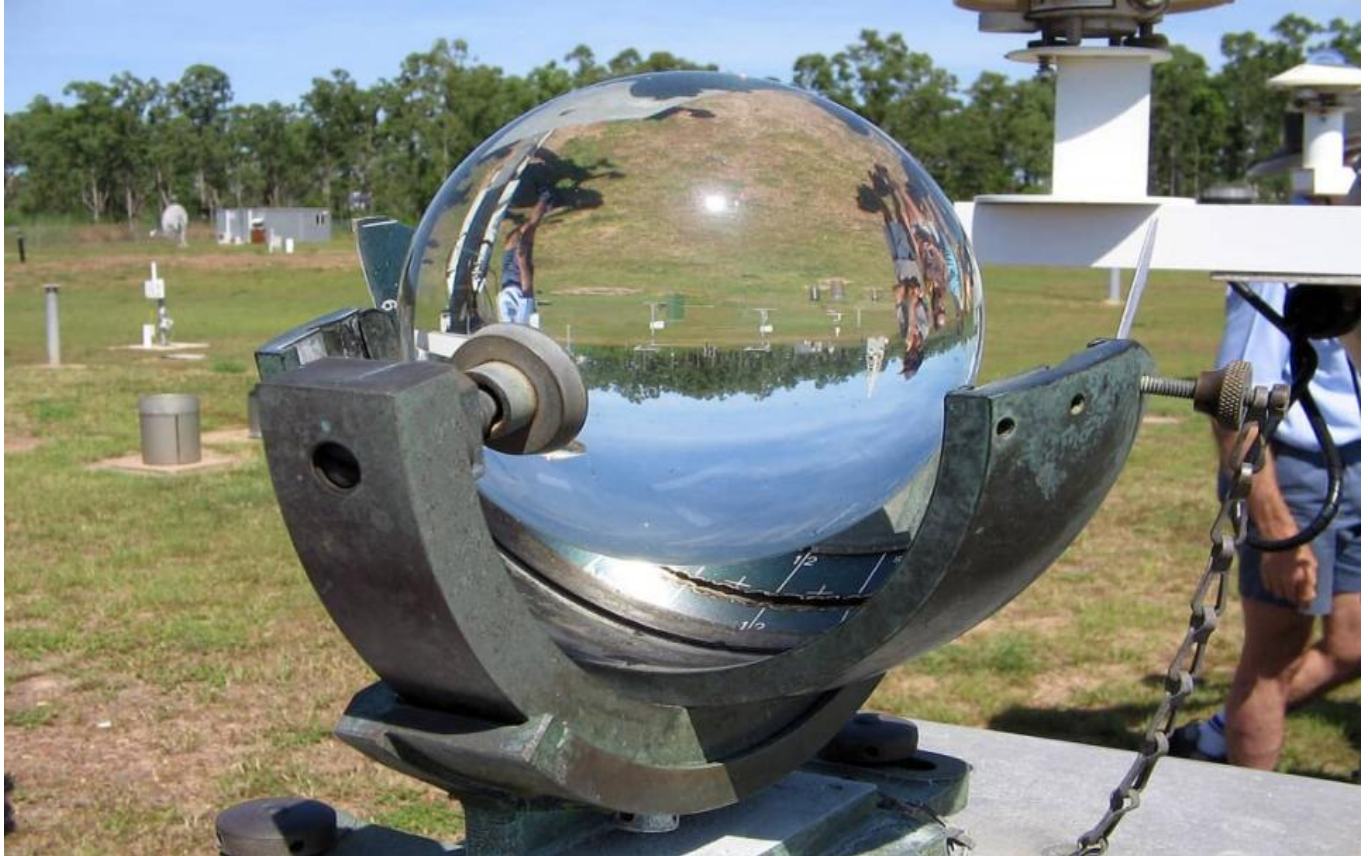
Figure 3 : Héliographe de Campbell-Stokes utilisé pour mesurer la durée .
