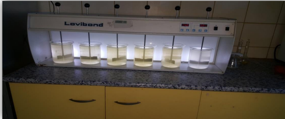
Figure.V.5 Essai N°04-02 JAR-TEST (FeCl 3 + polymère)
