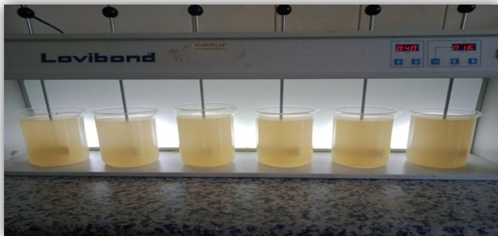
Figure.V.10 Essai N°03-02 JAR-TEST ( Al_2[SO_4]_3 + polymère)
