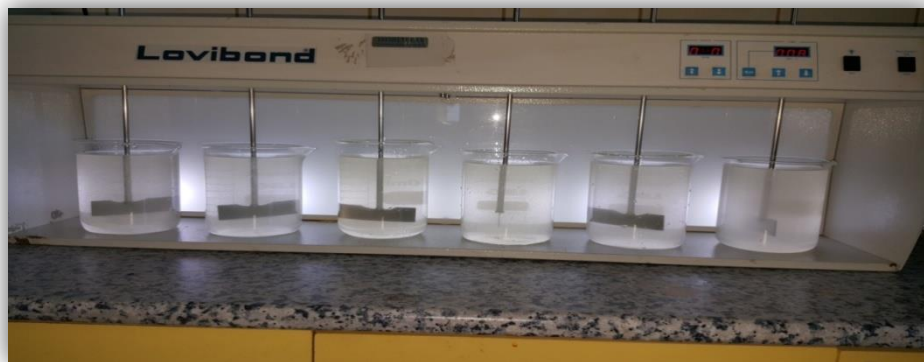
Figure.V.8 Essai N°01-02 JAR-TEST ( Al_2[SO_4]_3 + polymère)
