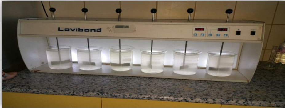
Figure.V.9 Essai N°02-02 JAR-TEST ( Al_2[SO_4]_3 + polymère)
