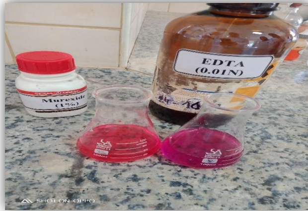
Figure IV.32 Résultats de titrage EDTA pour \text{Ca}^{2+}
