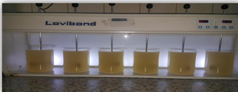
Figure.V.12 Essai N°06-02 JAR-TEST (FeCl 3 +polymère)
