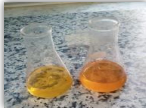
Figure. IV.30 Résultat de titrage ( \text{H}_2\text{SO}_4 [N/25])
