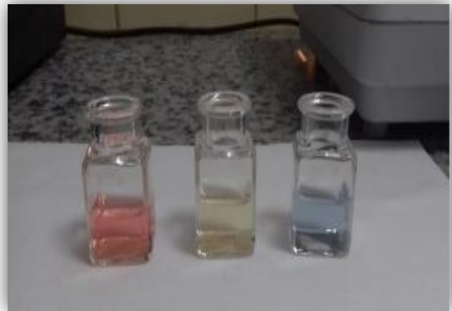
Figure. IV. 34 Couleur de présence des \text{PO}_4^{3-} , \text{NO}_3^- , \text{NO}_2^-
