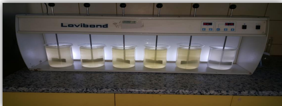
Figure.V.11 12 Essai N°05-02 JAR-TEST (FeCl 3 + polymère)
