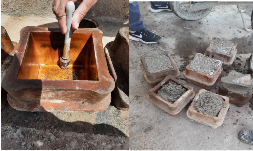
Figure II-20 : La mise en place du béton.
