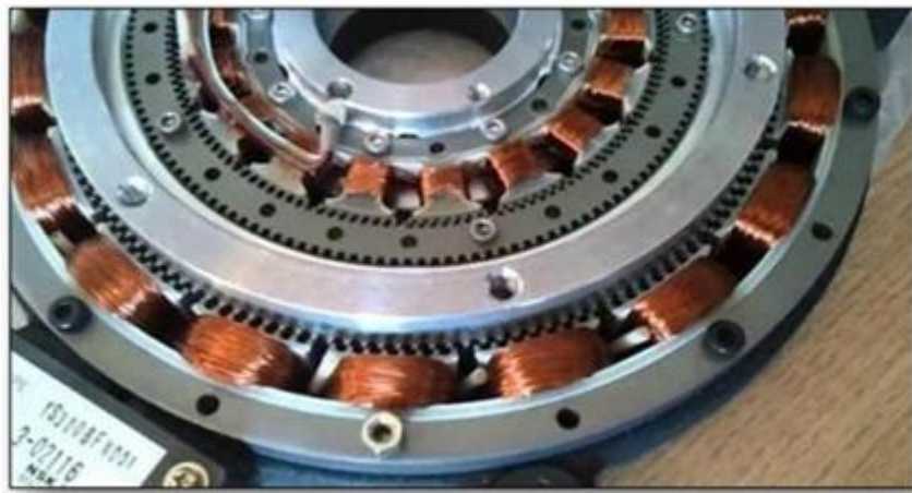
Figure(I.12) : MRV à effet vernier à stator externe et interne [4].
