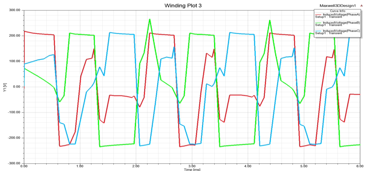
Figure III.13: Tensions induites en fonction de temps.
