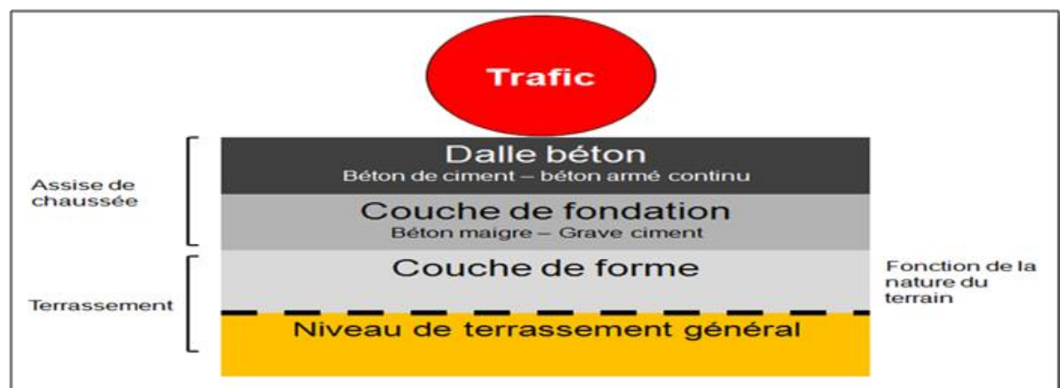
Figure VII.3 : Structure type d'une chaussée rigide.
