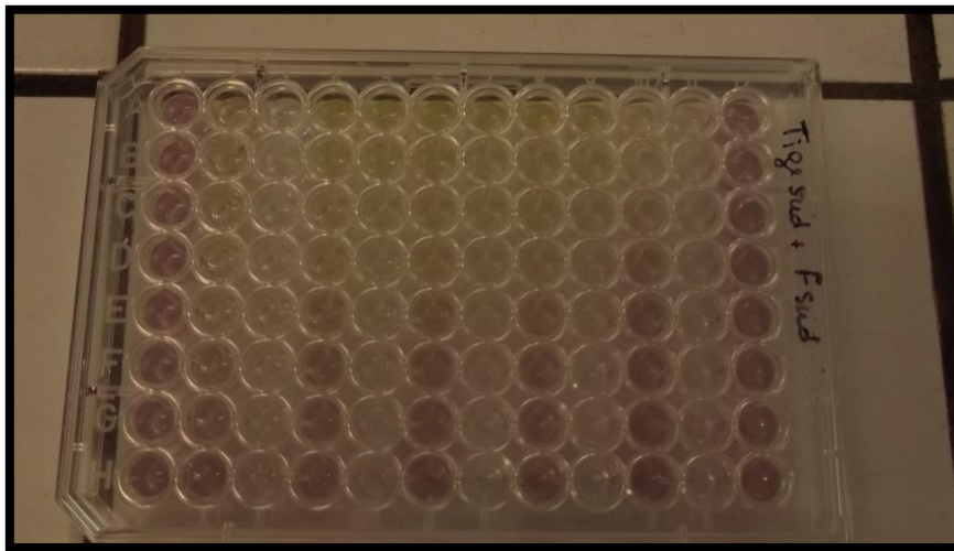
Figure 16: Test du DPPH en microplaques des tiges et des feuilles de H.tuberculatum .
