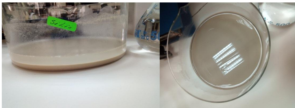
Figure V.24 : la décantation à l'air libre.
