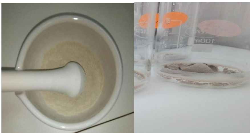
Figure V.25 : le broyage de la bentonite.
