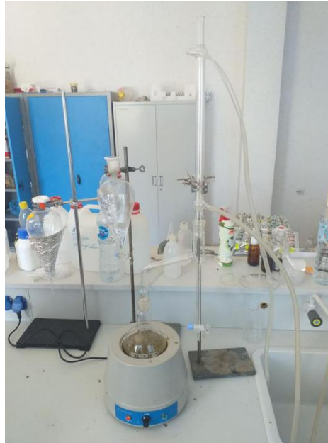
Figure 4 :le montage d'hydrodistillation employé pour l'extraction des huiles essentielles
