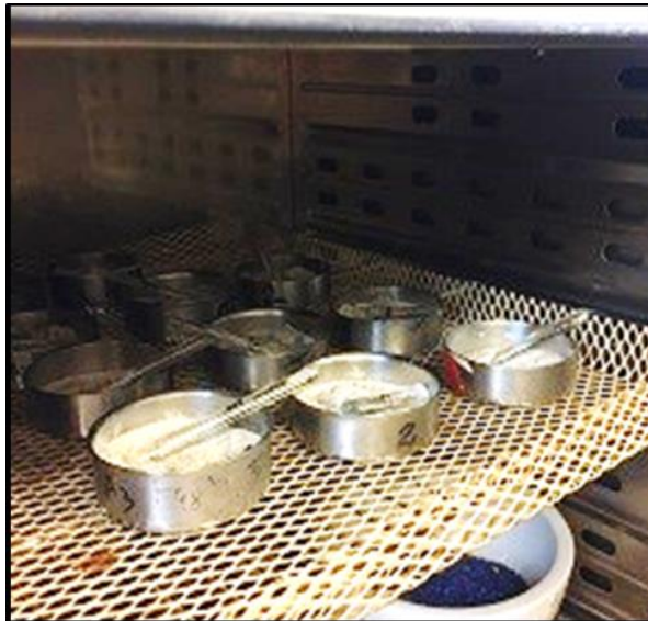
Figure 26. Séchage du tégument des espèces d'holothuries étudiées dans l'étuve à 103°C pendant 6 h.
