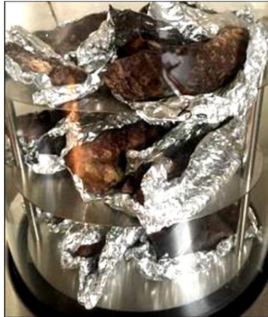
Figure 28. Lyophilisation des échantillons d'holothuries frais à -60°C pendant 72 h
