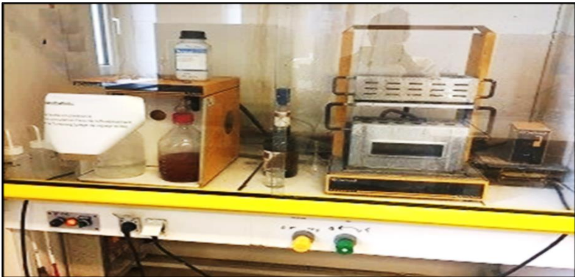
Figure 29. Dosage de la matière azotée selon la méthode de Kjeldahl.
