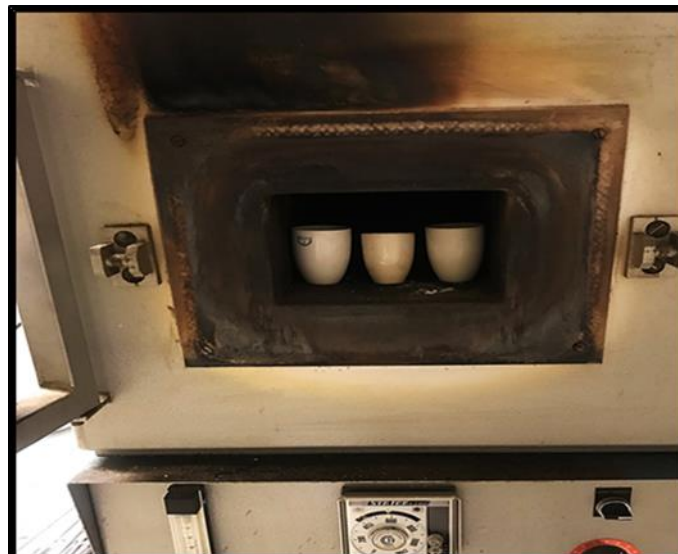
Figure 3. Incinération du tégument sec dans un four à moufle à 600°C pendant 12 h.
