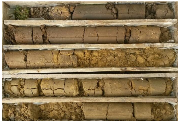
Figure 2 : caisse de carottes prélevées après un sondage
