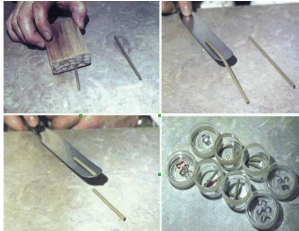
Figure 10 : Détermination de la limite de plasticité par la méthode du rouleau
