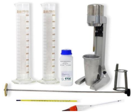
Figure 6 : matériels de l'essai sédimentométrique
